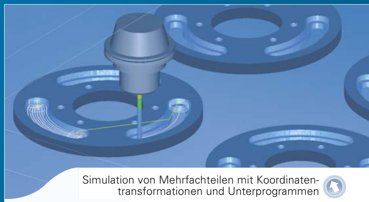
Simulation von Mehrschrittfräsen, Punktmustern mit Bohrungen und Gewinden sowie von Taschen
