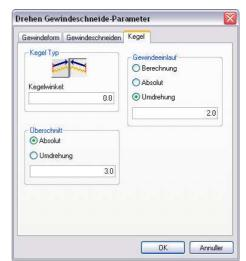
**Uberschnitt Absolut:** Wenn diese Option ausgewählt ist, wird das Werkzeug den Schnitt um die Länge am Ende des Gewindes fortsetzen, die sie im Eingabefeld eingeben.
