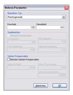
Benutze Spitzen Kompensation: Schaltet um auf die Benutzung von Spitzenkompensation. Diese Option wird für Bohrungen durch ein Werkstück hindurch eingesetzt. Sie erweitert das Loch anhand der Geometrie der Bohrung. Spitzen Winkel: Dies ist der Bohrwinkel.
