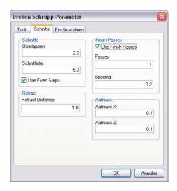
**Retract Distance:** Die Entfernung, um die sich das Werkzeug vom Material zurückzieht, bevor eine Rückbringbewegung ausgeführt wird.
