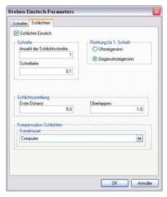
**Richtung für 1. Schnitt:** Der Schlichtschnitt wird von beiden Seiten ausgeführt. Die Richtung für 1. Schnitt ist die Richtung, in welche der erste der Schlichtschnitte ausgeführt werden soll.
