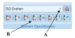
Wählen Sie dann die Funktion **Einstechen** aus, indem Sie auf die Schaltfläche *Einstechen* (Pfeil **B**) in der Werkzeugleiste *Drehen Operationen* klicken.
