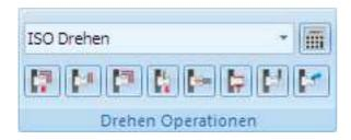
Die Werkzeugleiste *Drehen Operationen* gibt dem Benutzer Zugang zu diversen Operationen, die er für die Herstellung von Werkstücken benutzen kann. Alle Operationen können direkt nach CIMCO Edit exportiert werden oder in die Zwischenablage zum Einfügen an einem benutzerdefinierten Ort kopiert werden.
