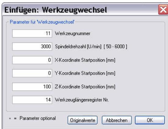
Abbildung 5.22: 'Makro-Eingabemaske' mit Parameterfeldern (Beispiel).
