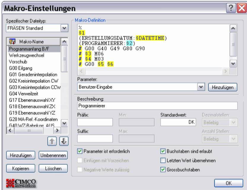
Abbildung 5.24: Zusatzbestimmung 'Buchstaben sind erlaubt'.
