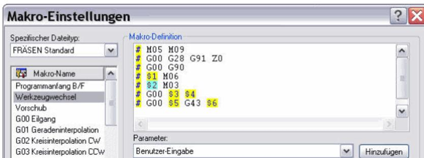
Abbildung 5.21: 'Makro-Definition' mit 6 Parametern (Beispiel).
