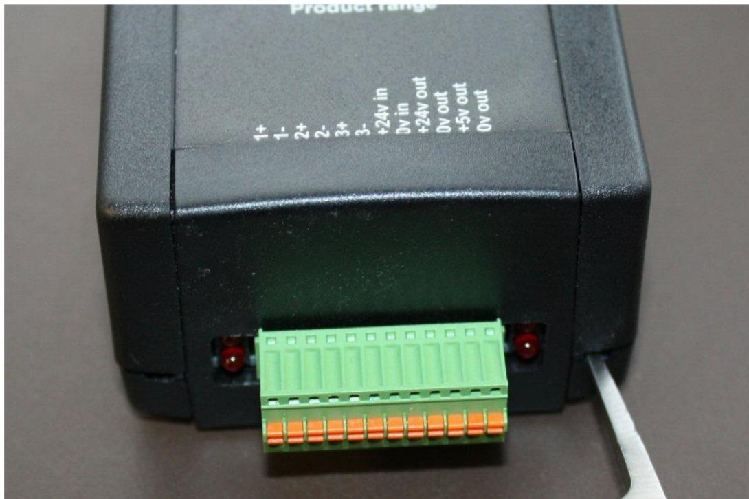
Pour ajuster les liaisons dans une unité MDC, vous devez ouvrir le boîtier. À chaque angle de l'extrémité du boîtier, se trouve un petit trou rectangulaire. Insérez un petit tournevis dans chaque trou tout en détachant doucement le couvercle. Une fois le boîtier ouvert, vous verrez le circuit imprimé comme indiqué ci-dessous.
