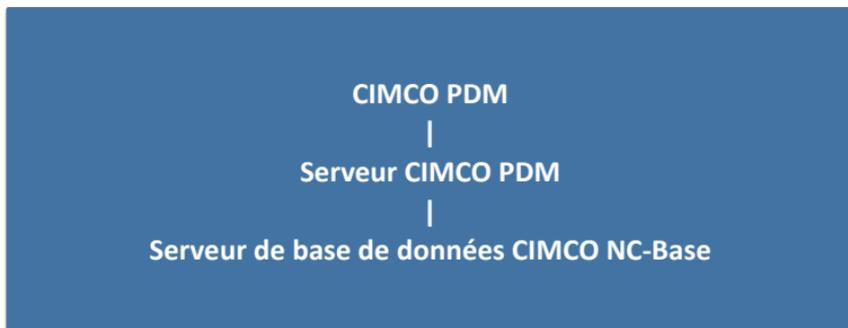
Pour faire fonctionner CIMCO PDM, vous devez installer à la fois CIMCO PDM et le serveur de base de données CIMCO NC-Base. Les deux logiciels peuvent être téléchargés sur [www.cimco.com](http://www.cimco.com), mais nécessitent une clé d'activation valide pour fonctionner. Le serveur CIMCO NC-Base fait partie du groupe de logiciels CIMCO Software version 6.
